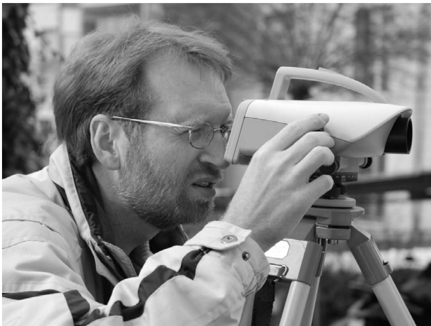
Philipp Kissling nimmt Messungen vor, während und nach Bauarbeiten Messungen an Gebäuden vor. So sollen mögliche Bauschäden rechtzeitig erkannt und verhindert oder zumindest dokumentiert werden.
